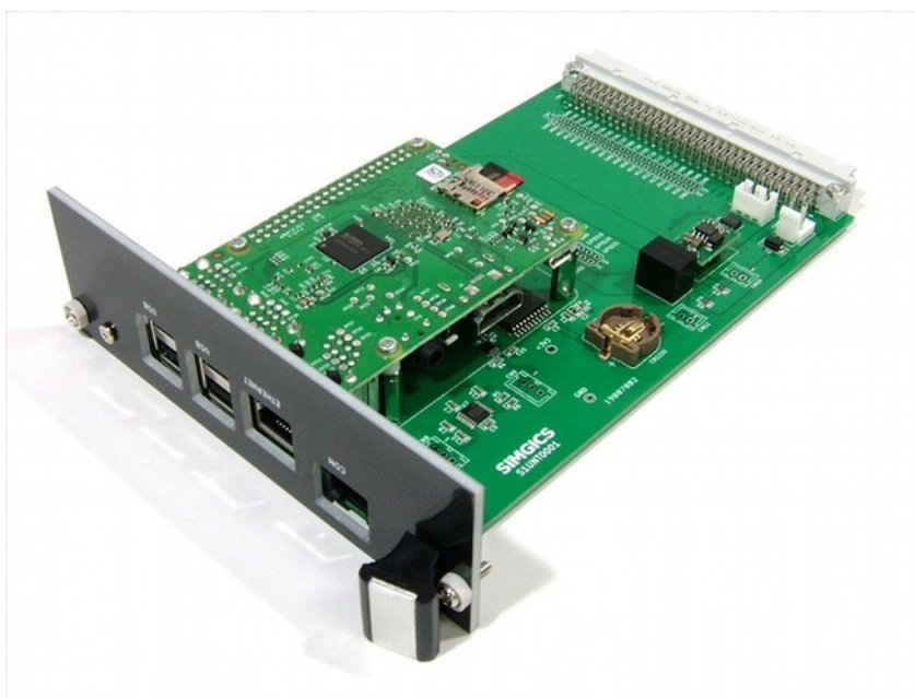
S1UNT0001 に Raspberry Pi を実装した様子
